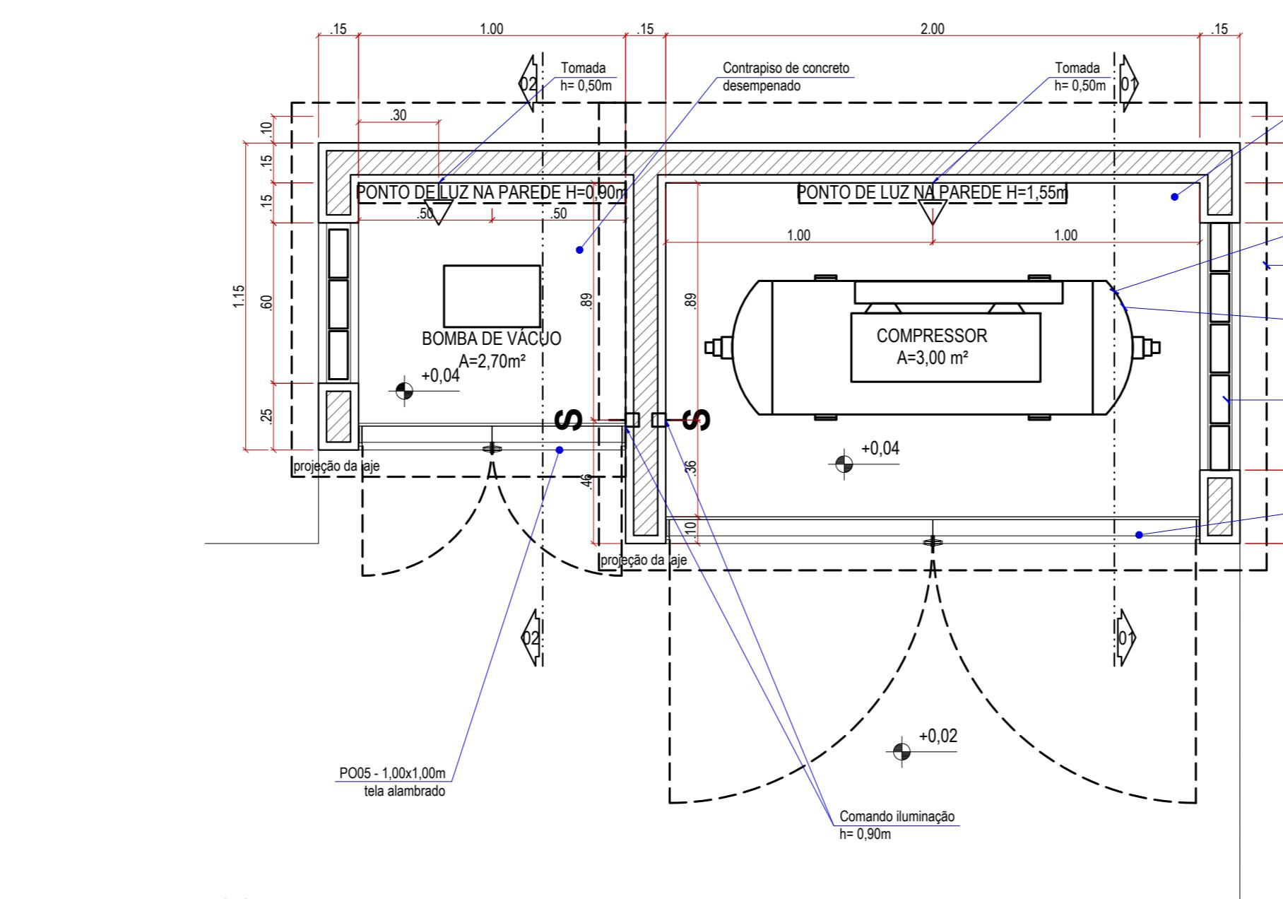
**DETALHE 40 - abrigo de compressor de ar e bomba de vácuo**
